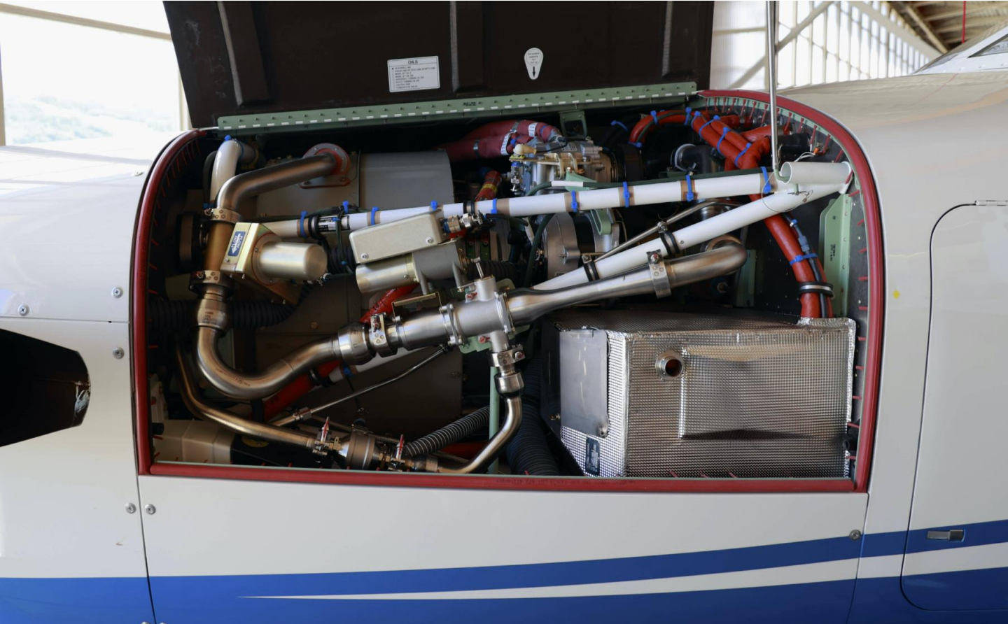
TBM 960 verfügt über das fortschrittlichste Triebwerk von Pratt und Whitney Canada, das PT6E-66XT. Foto Hansjörg Bürgi 7/13
