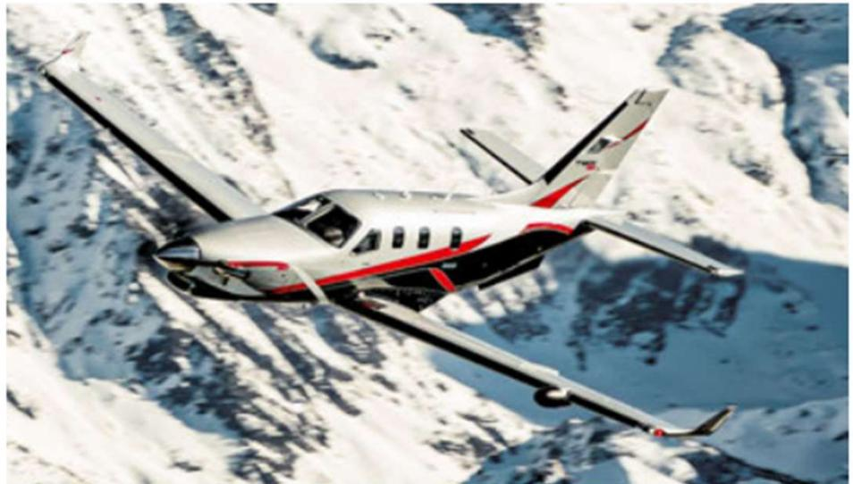
Die TBM 960 während eines Testfluges. Das Herzstück dieser neuesten TBM-Version ist das PT6E-66XT-Triebwerk und der fünfblättrige RaptorTM-Verbundpropeller von Hartzell.
